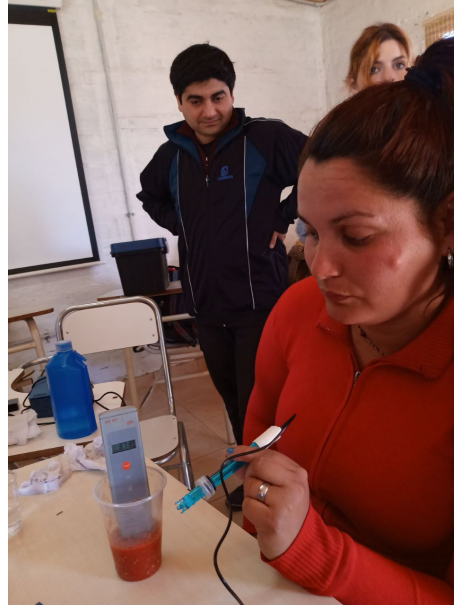
Figure 7: Medición de pH en conservas de tomate y comparación con peachímetro comercial
