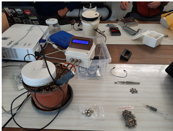
Figure 2: Demostración de la cámara de respiración de suelo
