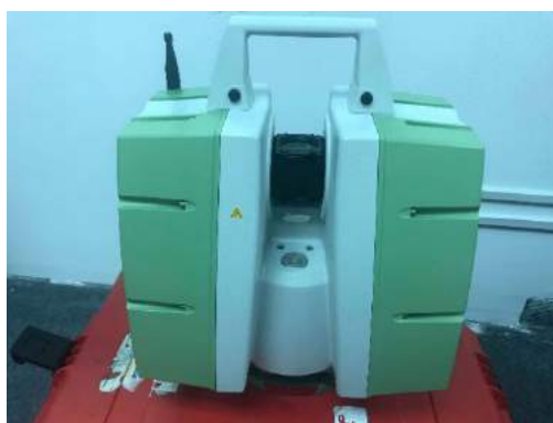
Figura 1. Láser escáner terrestre Leica P20. Fuente: Leica Geosystems.
