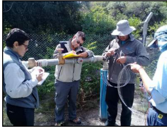
Figura 3. Instalación del diver en la perforación y medición del nivel estático.
