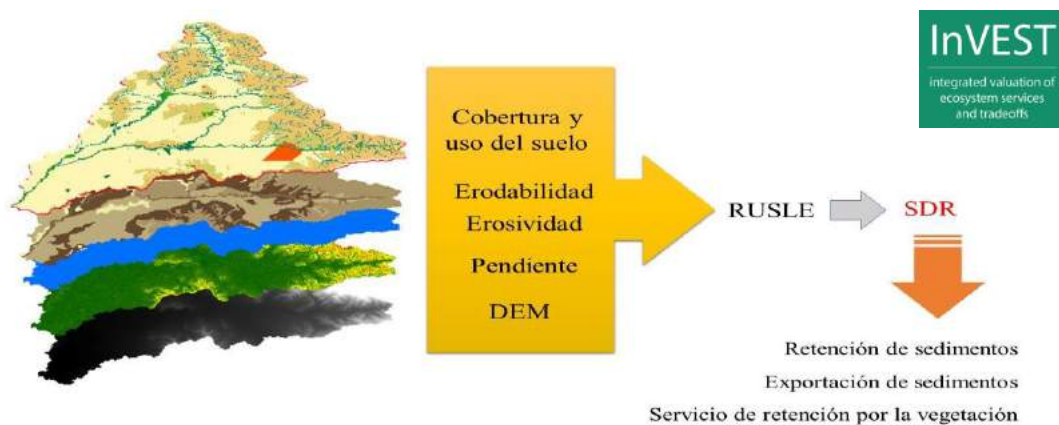
Figura 2. Modelo cartográfico aplicado para la obtención del SDR en la cuenca alta del Rio Sauce Chico.
