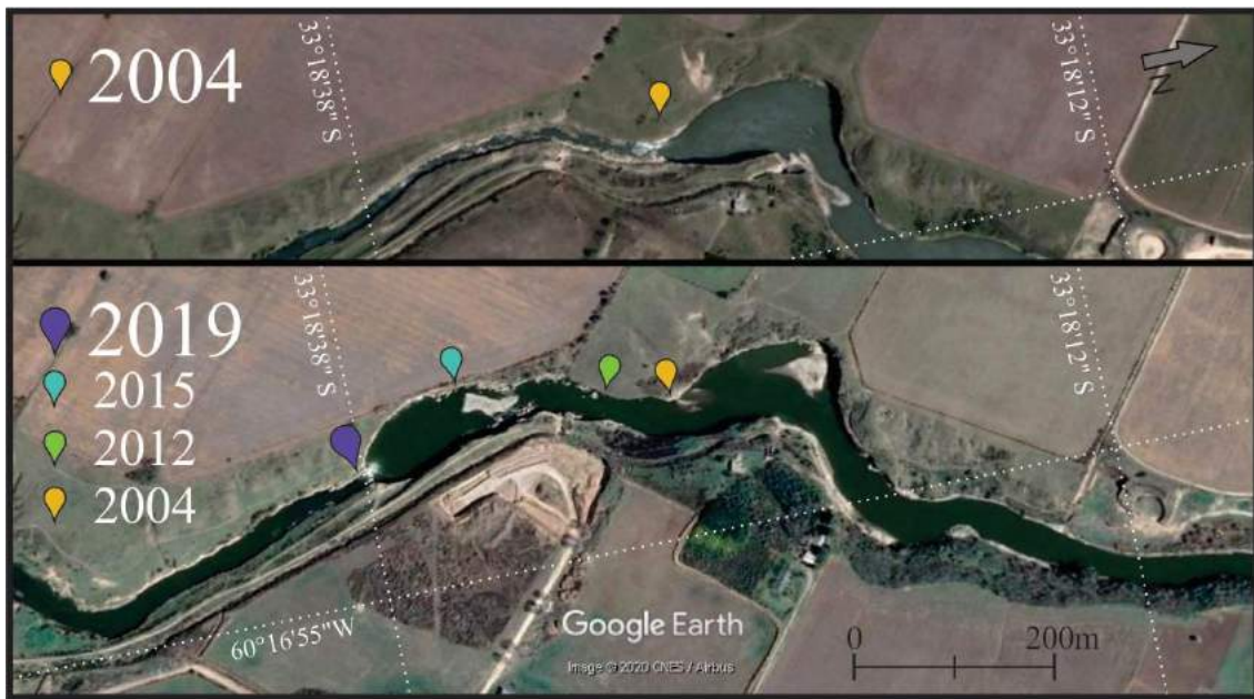
Figura 5. Retroceso del salto del arroyo del Medio. El canal del frigorífico La Elisa es visible en la margen derecha del arroyo, cuyas paredes fueron desgastadas por la erosión retrocedente del salto.
