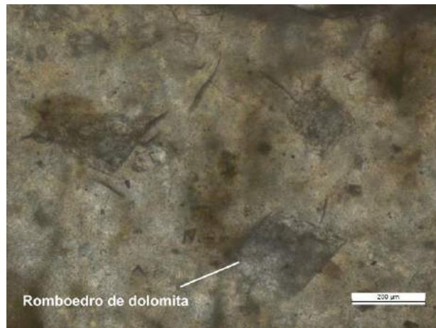
Fotografía 6. PLC, Evidencia de procesos de dolomitización
