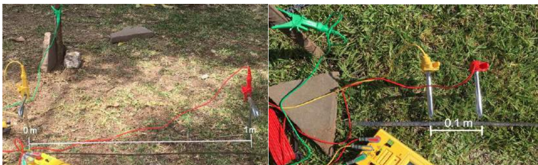
Figura 1. Imagen 1 zona de muestreo A, imagen 2 zona de muestreo B. Se observan las separaciones máximas de los electrodos en cada zona de muestreo y los materiales utilizados.
