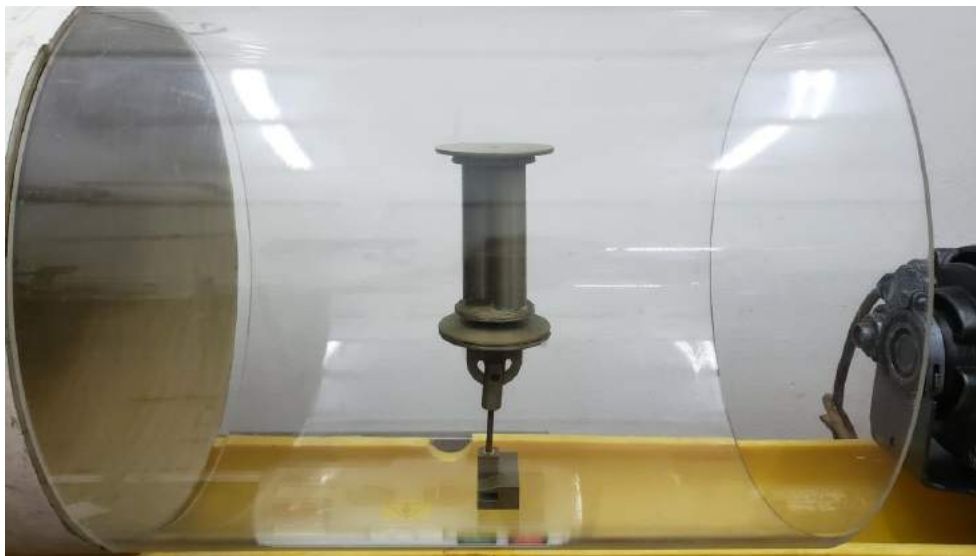
Figura 1. Sección de Prueba del Túnel de Viento en construcción ubicado en el laboratorio Perfil Alar. En su interior se encuentra un aerogenerador Savonius en escala impreso en 3D. Fuente: elaboración propia.
