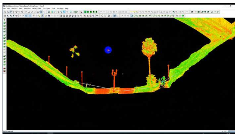
Figura 17. Nube de punto depurada de vehículos.
