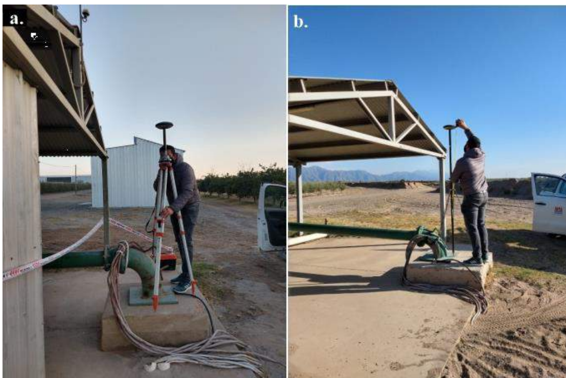
Figura 3. a. Instalación de base de GPS Geodésico b. Nivelación del Rover en boca de pozo (Fotos: Miguel, R.E.)
