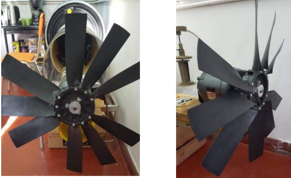
Figura 2. Modelo de Ventilador a utilizar en el túnel de viento. Fuente: elaboración propia.
