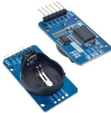
Fig.4. MóduloDS3231(Relox de alta precisión). Imagen extraída del manual de uso del fabricante.
