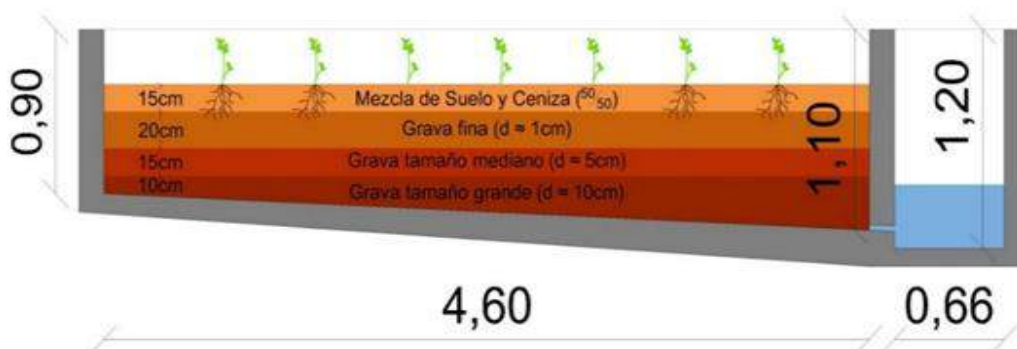
Figura 5. Esquema de relleno en los módulos de depuración vegetal (MDV) para biorremediación de suelos y/o aguas contaminadas.
