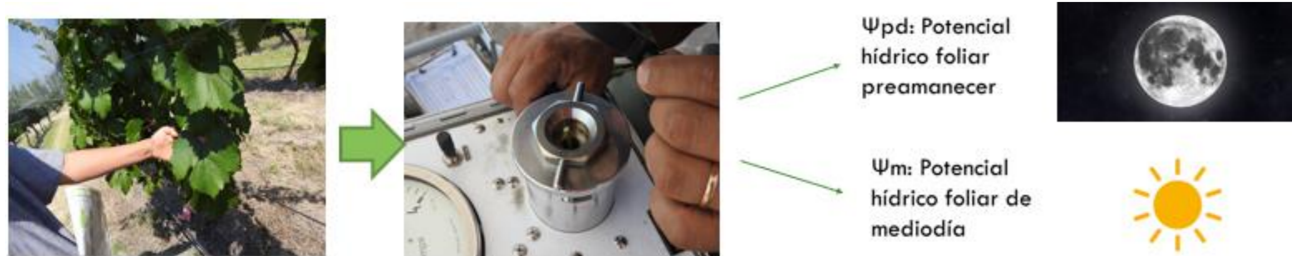
Figura 2. Procedimiento de determinación de potencial hídrico foliar, mediante la visualización de la primera gota de savia en cámara Schölander presurizada con nitrógeno.
